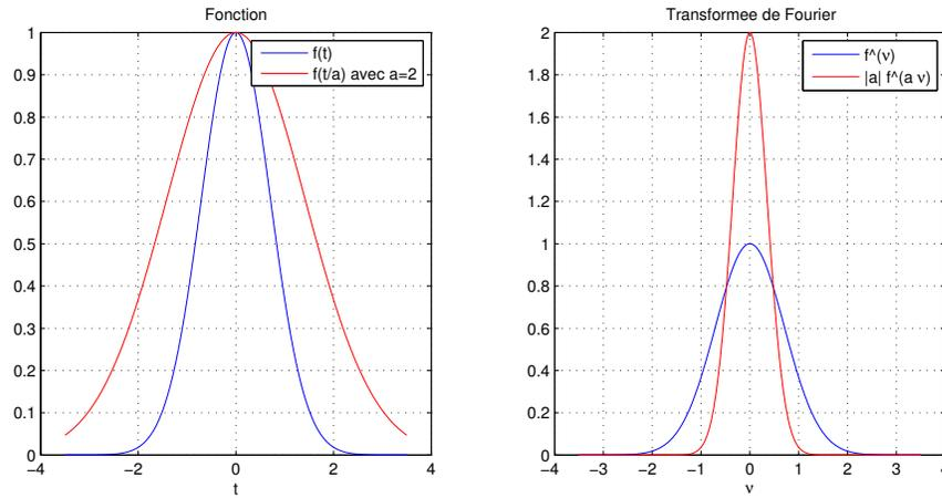
FIGURE 3.3 – Illustration de la propriété de changement d’échelle. A gauche une fonction gaussienne  $f(t)$  (bleu) et la même fonction  $f(t/a)$  dilatée d’un facteur  $a = 2$  (rouge). A droite les TF respectives : noter l’inversion des proportions (la dilatation dans l’espace direct est devenue une compression dans l’espace de Fourier). On note aussi la valeur à l’origine dans l’espace de Fourier, plus élevée pour la courbe rouge ( $\hat{f}(0)$  est l’intégrale de  $f$ ).
