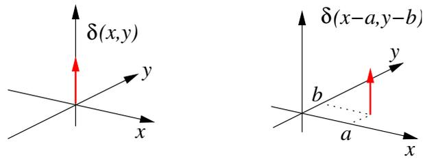
FIGURE 1.3 – Représentation en perspective du pic de Dirac à deux dimensions. À gauche  $\delta(x, y)$  est centré à l'origine. À droite  $\delta(x - a, y - b)$  représente une distribution  $\delta$  centrée au point de coordonnées  $(a, b)$
