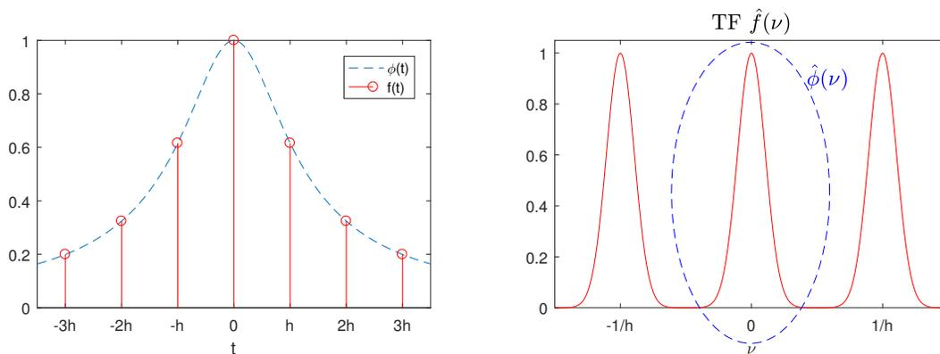
FIGURE 4.7 – Allure de la transformée de Fourier d’une fonction échantillonnée. A gauche : graphe d’une fonction continue  $\phi(t)$  et de son échantillonnée  $f(t)$ , constituée d’une somme de pics de Dirac (le pas d’échantillonnage est  $h$ ). A droite la TF de  $f(t)$ . C’est une fonction périodique dont le motif est égal à  $\hat{\phi}$  et la période  $\frac{1}{h}$ .
