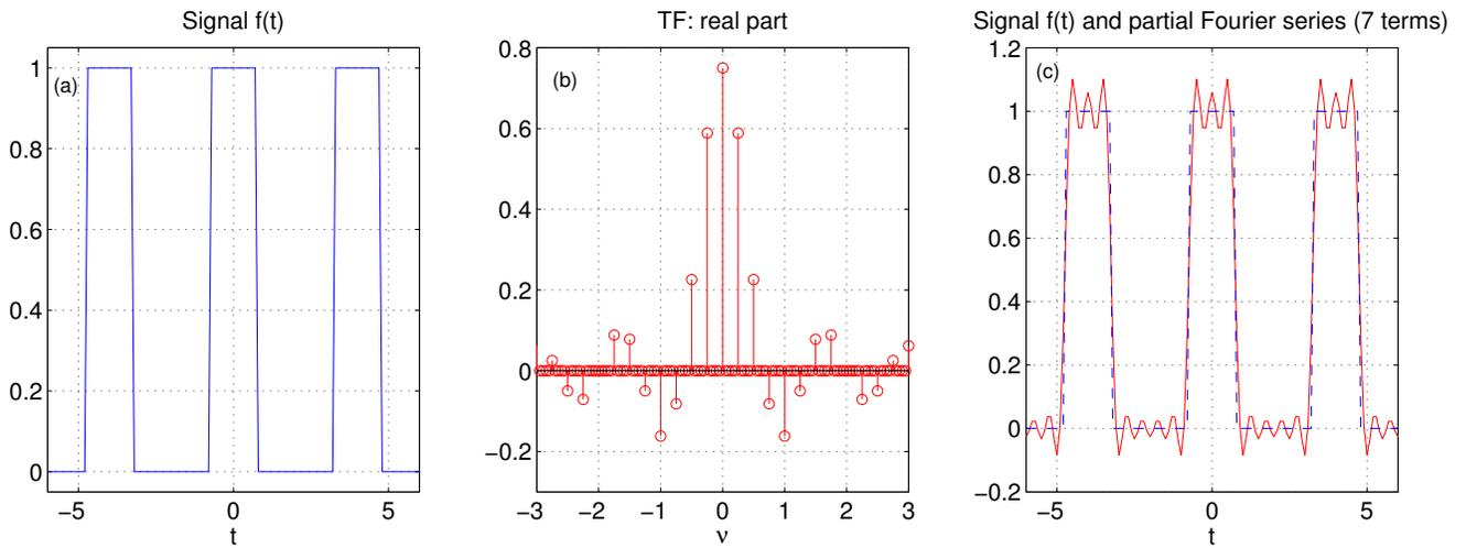
FIGURE 4.4 – (a) : signal en créneaux carrés de largeur  $a = 1.5$  et de période  $T = 4$ . (b) : sa TF (partie réelle), constituée de pics de Dirac d'intégrale  $c_n$  centrés aux fréquences  $\frac{n}{T}$ . (c) : le signal (pointillés) et la somme des 7 premiers termes de sa série de Fourier (eq. 4.29)
