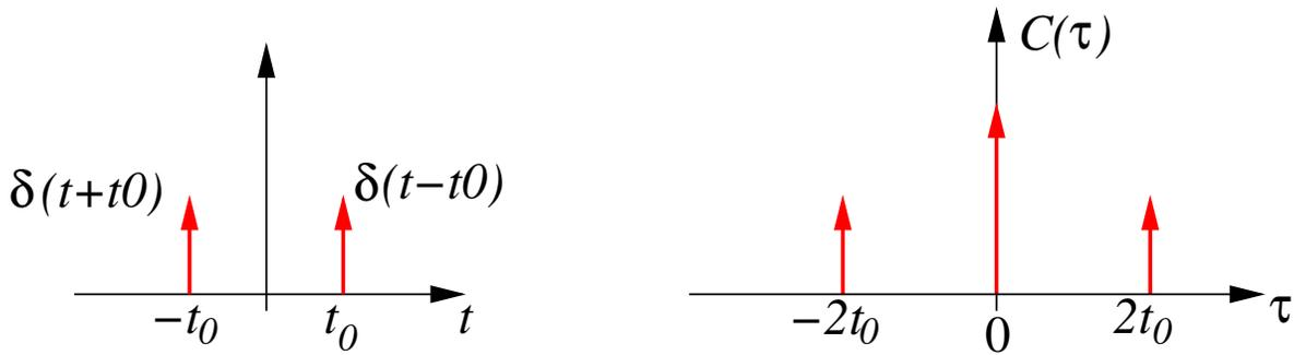
FIGURE 3.13 – A gauche, la somme de deux pics de Diracs d'intégrale 1, centrés en  $\pm t_0$ . A droite, l'autocorrélation est une fonction symétrique, somme de trois Diracs centrés en 0 et  $\pm 2t_0$ . Le pic central a une intégrale 2 fois plus importante que les pics latéraux. La distance entre le pic central et l'un des pics latéraux est égale à la séparation entre les Diracs qui constituent la fonction.
