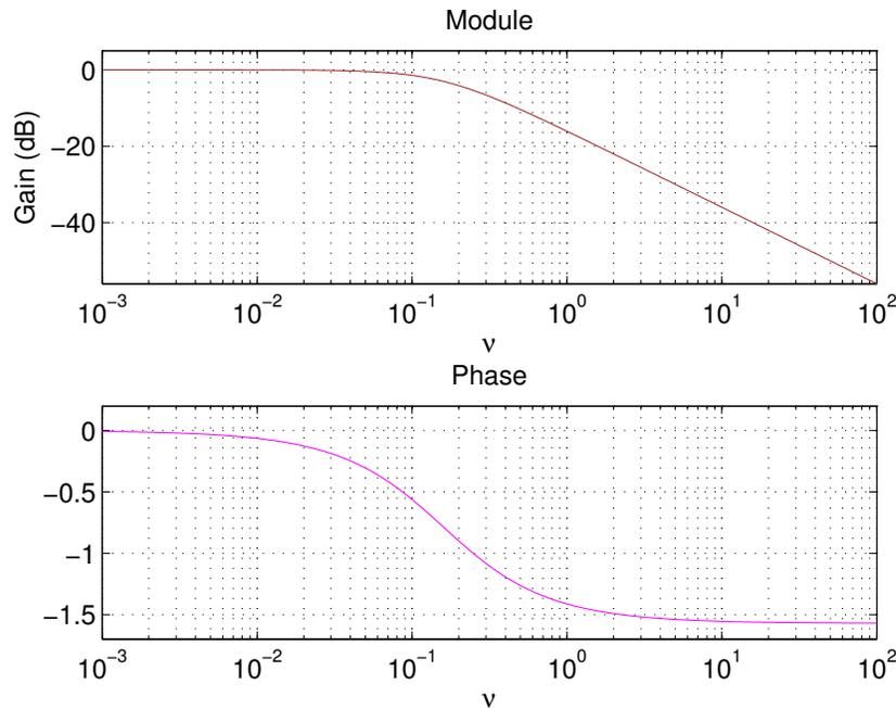
FIGURE 3.10 – Diagramme de Bode de la fonction de transfert  $\hat{R}(\nu)$  du circuit RC pour  $RC = 1$ . En haut le gain  $G(\nu) = 20 \log_{10}(|\hat{R}(\nu)|)$  en fonction de  $\nu$ . En bas la phase de  $\hat{R}(\nu)$  en fonction de  $\nu$ .
