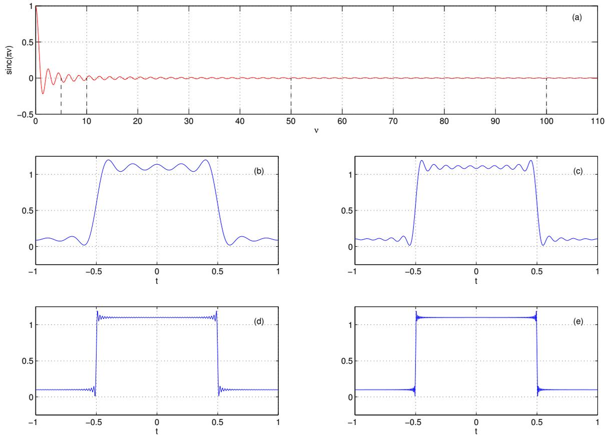
FIGURE 3.6 – Construction d’une fonction porte  $f(t) = \Pi(t)$  par sommation de la série (eq. 3.40) avec  $\delta\nu = 0.01$ . (a) : TF de la fonction porte  $\text{sinc}(\pi\nu)$ . (b) à (e) : calcul de la série pour 4 valeurs maximales  $\nu_M$  de  $\nu$  correspondant à  $\nu_M = 5, 10, 50, 100$  (c’est à dire une borne supérieure  $M = 500, 1000, 5000, 10000$  pour  $n$ ). Les lignes verticales du graphe (a) correspondent aux 4 valeurs de  $\nu_M$ .
