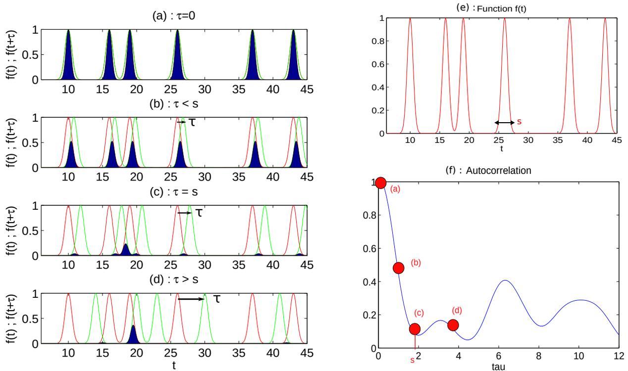
FIGURE 3.14 – Exemple de calcul d'une autocorrélation pour un signal  $f(t)$  constitué d'une série de pulses de largeur  $s$ . Les graphes (a) à (d) montrent le recouvrement de  $f(t)$  et de  $f(t+\tau)$  pour 4 valeurs de  $\tau$ . Le graphe (f) est l'autocorrélation en fonction de  $\tau$ . Les disques rouges correspondent à chacun des cas (a) à (d).
