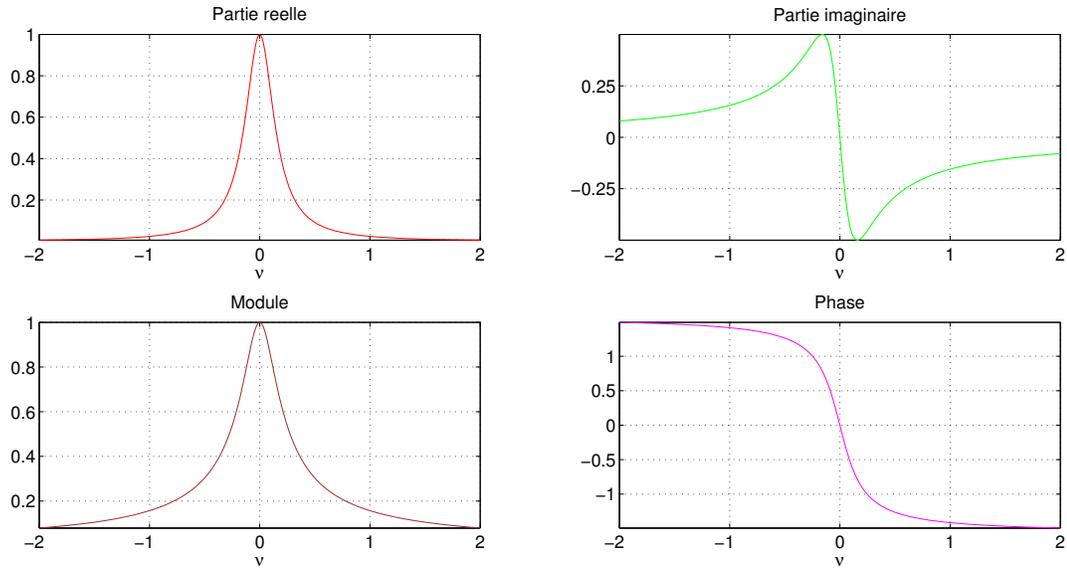
FIGURE 3.9 – Fonction de transfert du circuit RC pour  $RC = 1$ .
