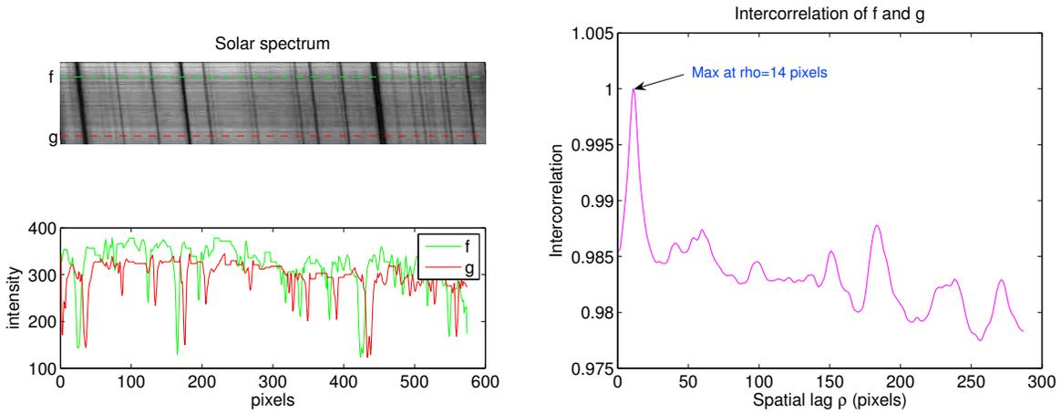
FIGURE 3.15 – En haut à gauche : un spectre solaire dont les raies sont inclinées. En bas à gauche : profil d'intensité du spectre mesuré sur les deux lignes  $f$  et  $g$  en pointillés, et qui présentent entre elles un décalage  $\Delta$ . A droite, l'intercorrélation de  $f$  et  $g$ .
