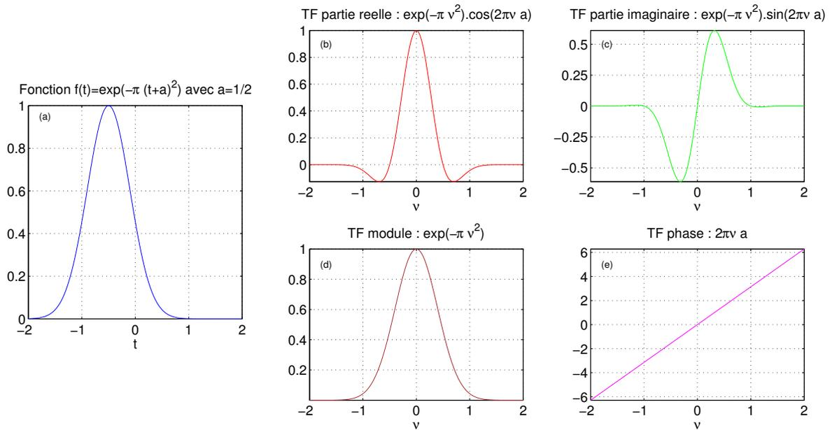
FIGURE 3.4 – Effet d’un changement d’origine (translation) sur la transformée de Fourier d’une gaussienne. (a) : fonction gaussienne traduite d’une quantité  $a = \frac{1}{2}$  dans l’espace direct. (b) et (c) : parties réelle et imaginaire de la TF. (d) : module de la TF, indépendant du décalage  $a$ . (e) : phase de la TF, c’est une droite de pente  $2\pi a$ . La pente est positive si la fonction est décalée vers la gauche, négative si la fonction est décalée vers la droite.
