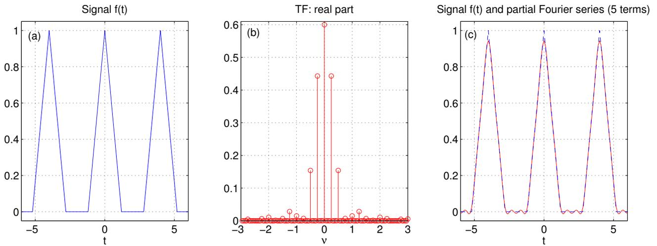
FIGURE 4.5 – (a) : signal triangulaire de période  $T = 4$ , la largeur des triangles est  $2a = 2.4$ . (b) : sa TF (partie réelle) : la position des pics de Dirac est la même que dans le cas de la fonction créneau (fig. 4.4b), mais leur intégrale (coefficient  $c_n$ ) est différente. (c) : le signal (pointillés) et la somme des 5 premiers termes de sa série de Fourier (eq. 4.31)
