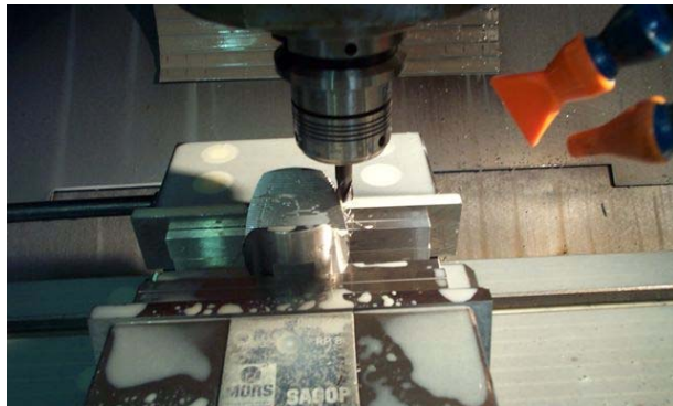
Usinage d'un support point trait plan pour table optique
