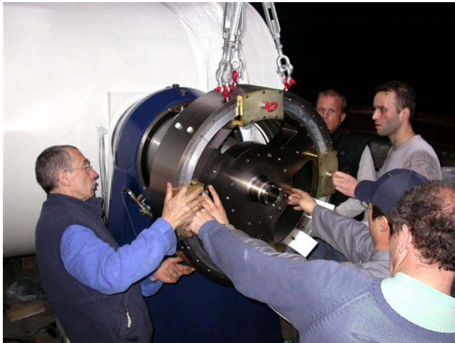
Mise en place moteur élévation DT-INSU
