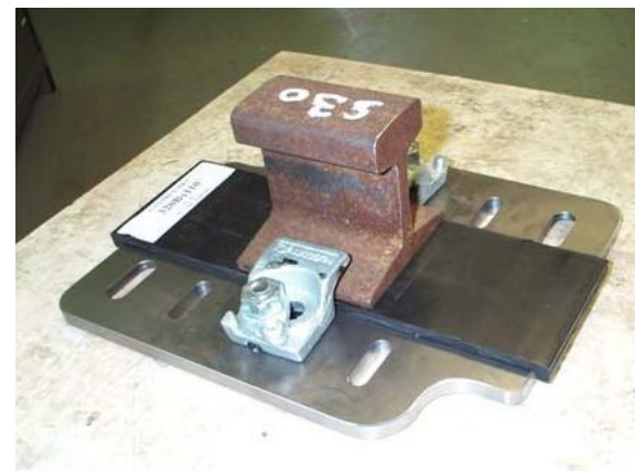
Test de montage du rail de la coupole
