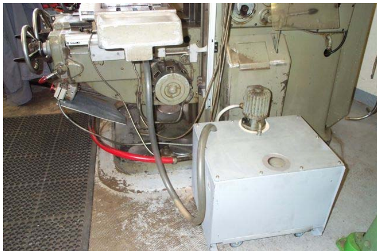
Modification du système d'arrosage de la Fraiseuse Gambin
