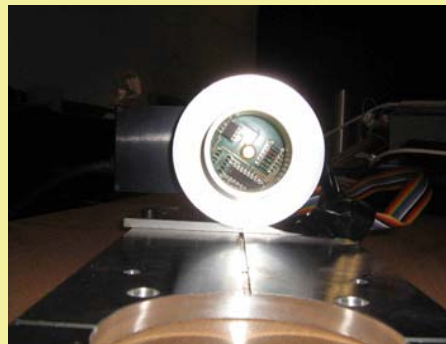
boîtier détecteur fixé sur plaque tournante
