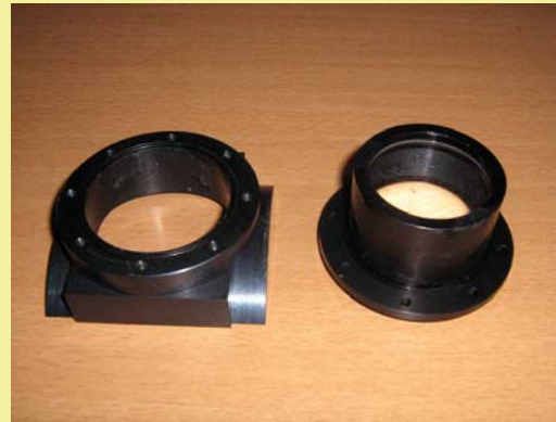
boîtier détecteur fixé sur plaque tournante
